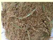
Die Rasentragschicht wird mit 18 cm langen, zufällig verteilten Kunststofffasern vermischt.
