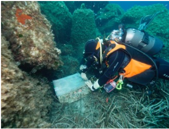
Abbaubarkeit von Kunststoffen Verschiedene Kunststoffsorten in unterschiedlichen Habitaten STARESO, Korsika, Mittelmeer
