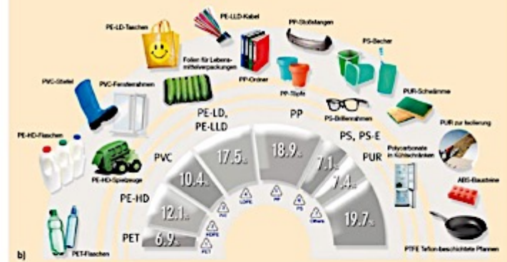
a) Strukturformeln einiger in diesem Artikel erwähnter Kunststoffe; die grüne Beschriftung weist auf biobasierte Kunststoffe hin, die vollständig oder teilweise aus nachwachsenden Rohstoffen bestehen. b) Verbrauch von Menschenkunststoffen für verschiedene Anwendungen in Europa 2013; innerer Ring: s. Wikipedia → Recycling-Code (Quelle: www.plasticseurope.org → Plastics the Facts 2014/2015).
